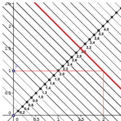
Abb. 11: Nomogramm zur Addition von  $x$  und  $y$ : Verfolge rote Linie vom Punkt  $(x,y)$  bis zur Diagonalen.
