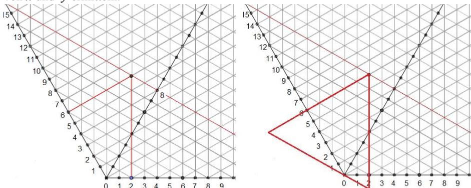
Abb. 12: Hexagonales Nomogramm zur Addition. Rechts: Verbindung zu Lotfußpunkten im gleichseitigen Dreieck.
