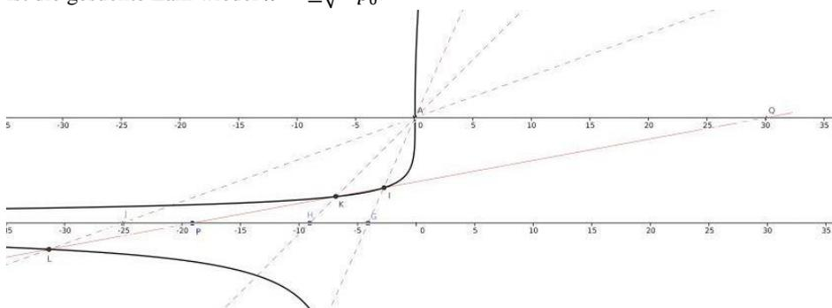
Abb. 14: Nomogramm mit nur einer Kurve zur Lösung kubischer Gleichungen
