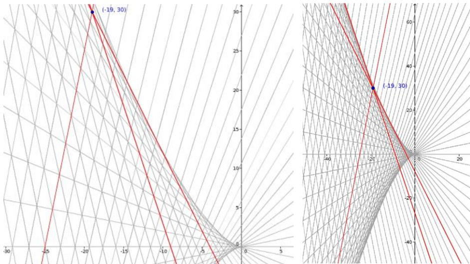
Abb. 13: Nomogramme zur Lösung kubischer Gleichungen. Beispiel  $x^3 - 19x + 30 = 0$ .
