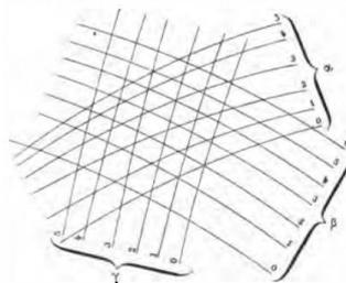
Abb. 9: Illustration eines allgemeinen Prinzips für Nomogramme in drei Variablen (aus (d'Ocagne, 1891)).
