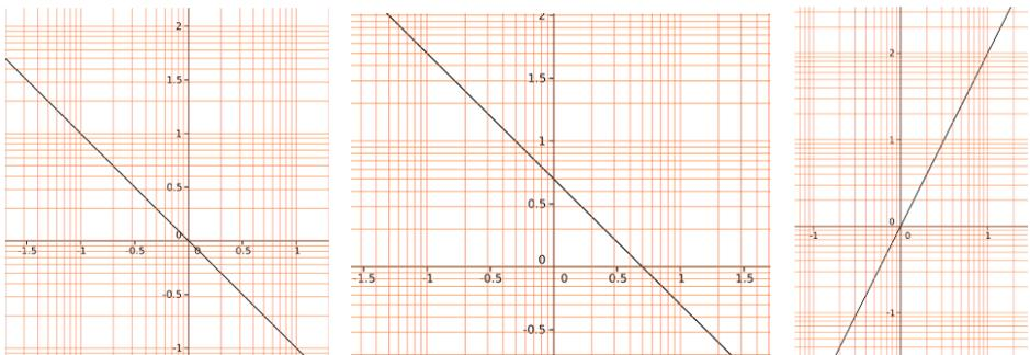
Abb. 8: Doppeltlogarithmische Darstellung von:  $f(x) = \frac{1}{x}$  sowie  $f(x) = \frac{5}{x}$  und  $f(x) = x^2$  (v.l.n.r.)
