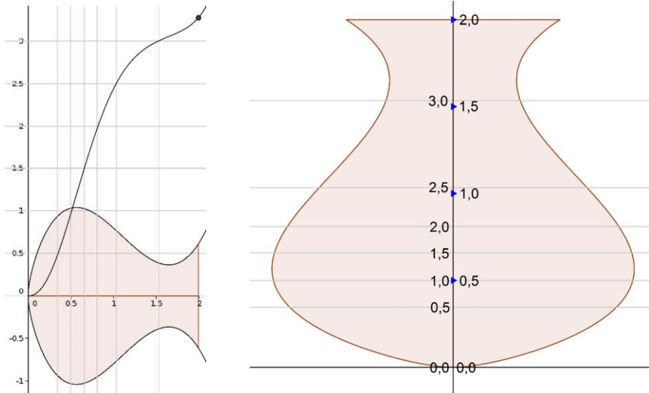
Abb. 2: Erstellen einer Skala aus dem Füllgraphen (links) und eine Weinkaraffe als Messbecher (rechts)
