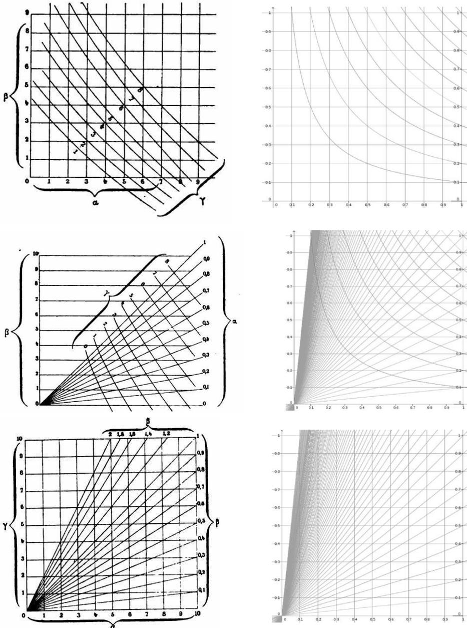
Abb. 10: Allgemeine schematische Illustration aus d'Ocagne (1891), rechts Nomogramme zur Multiplikation.
